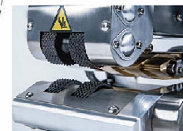
Estructura de colocación de membranas
